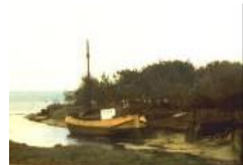
Frachtsegler Mathilde , Krautsand 1956 Maße: 20 x 5 m, 1,2 m Tiefgang, 180 m 2 Segel aus Stahl mit Plattboden
